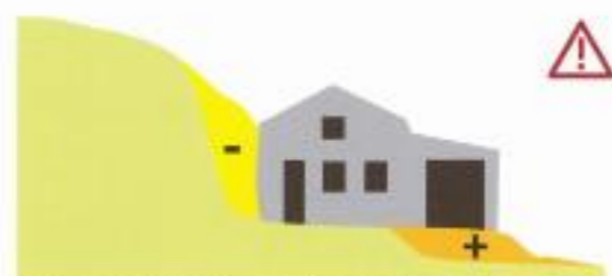
Cette configuration peut provoquer un risque de glissement de terrain, elle crée une cicatrice dans le couvert végétal et dans le paysage.
